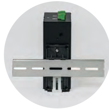
DINレール固定板 下部取付時
