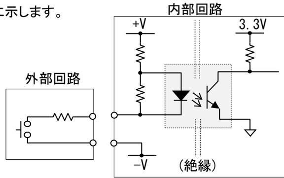
図 入力接点回路構成
