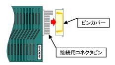
メディアコンバータのコネクタ部と本装置のコネクタピンを合わせ真っ直ぐに差込みます。取付け時には本装置のコネクタピンがメディアコンバータのコネクタ部に接触するように奥まで真っ直ぐに差込みます。斜めやずれて差込むとコネクタピンの変形や折れが発生し、誤動作や故障の原因になることがあります。
