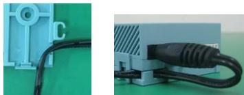
最後に電源プラグ(ACアダプタの本体部)をACコンセントに確実に差し込んで下さい。
