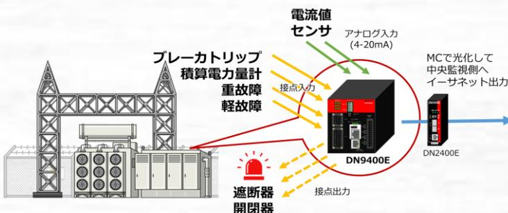
設備の状態をイーサネット出力することで、中央監視側から遠隔での監視を実現します(MCを利用すると長距離伝送が可能です)。接点やアナログ入力値に連動して接点出力するシーケンスを設定すれば、遮断器の制御や警報接点として利用できます。
