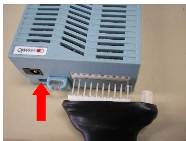
監視 MC への取付け
